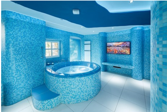
Bild 1: Die Manufaktur Hilpert glasierte die Keramik für die Trittstufe des Whirlpools rutschhemmend und in passender Farbe. Zusammen mit der Griffstange an der Wand schafft das Sicherheit beim Ein- und Ausstieg. Bild: Hilpert GmbH & Co. KG
